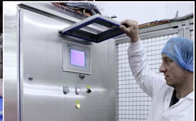
Das klappbare Sichtfenster sorgt beim Reinigen für zusätzlichen Schutz des im HD-Gehäuse eingelassenen Displays.
