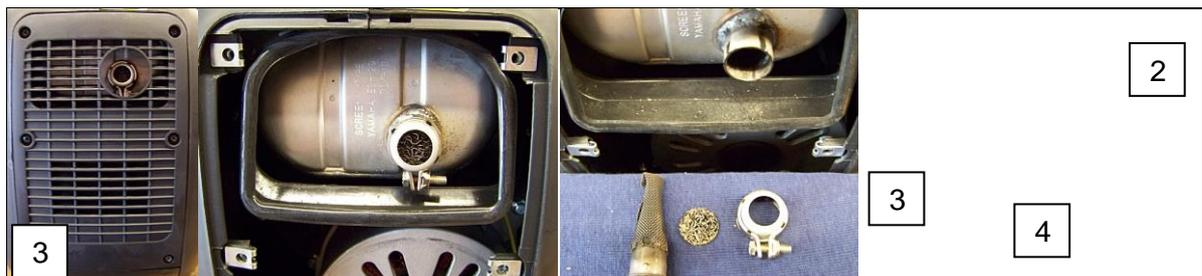
Abbildung- 14: Funkenfänger reinigen
