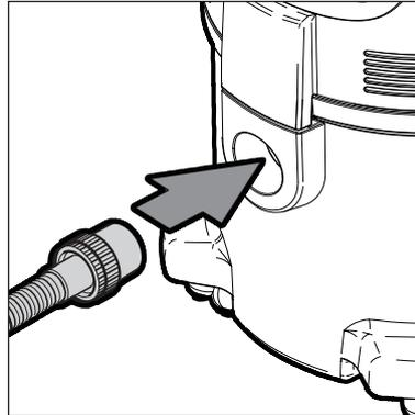
1. Saugschlauch am Sauger anschließen.
