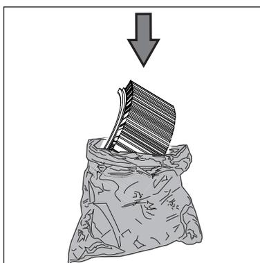
5. Filterschutzbeutel über das Filterelement stülpen.
