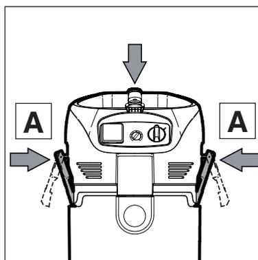
11. Saugerteil auf den Schmutzbehälter aufsetzen.
