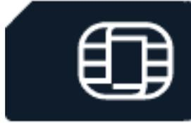
**Wichtig:** Dieses Gerät ist ausschließlich für die Verwendung mit einer Mini-SIM-Karte vorgesehen (siehe Abbildung). Die Verwendung inkompatibler SIM-Karten kann die Karte oder das Gerät beschädigen und die auf der Karte gespeicherten Daten beschädigen.
