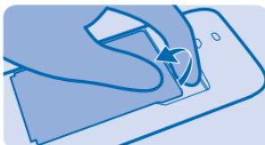
3. Schieben Sie die SIM-Karte mit der Kontaktfläche nach unten hinein.
