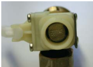
Siebeinsatz im Zulauf des Ventils eingesetzt
