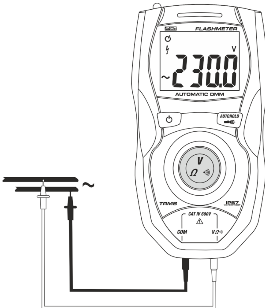
Abb. 4: Verwendung des Gerätes für Wechselspannungsmessung
