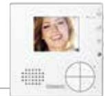
Alte, analoge Audiosysteme lassen sich mit der 2-Draht-Technik einfach auf neue Farbvideosysteme aufrüsten.
