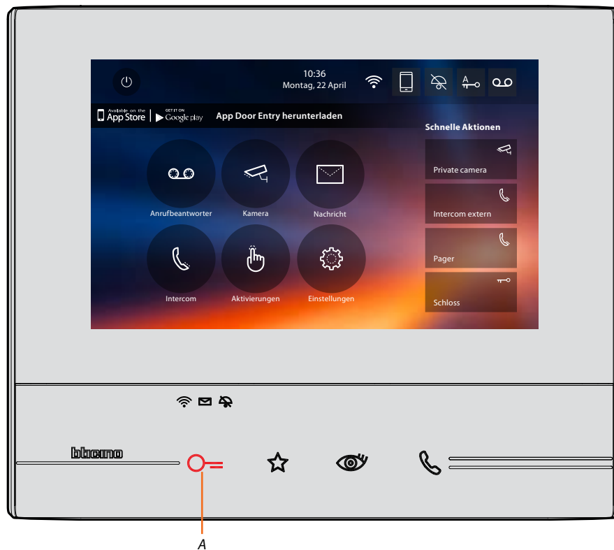
A. Blinkende LED = Schloss geöffnet
