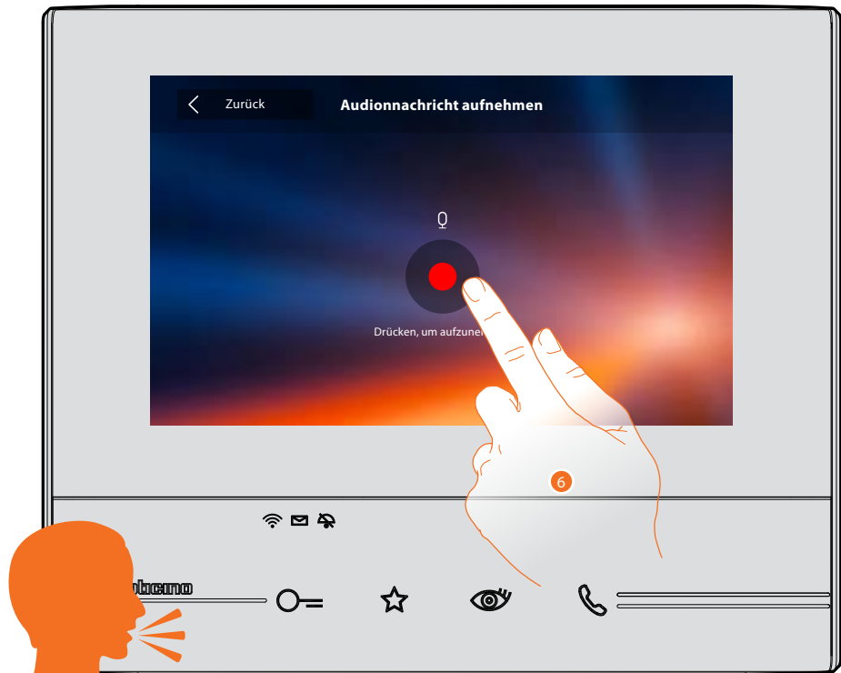
6. Aufnahme starten und die Nachricht sprechen.
