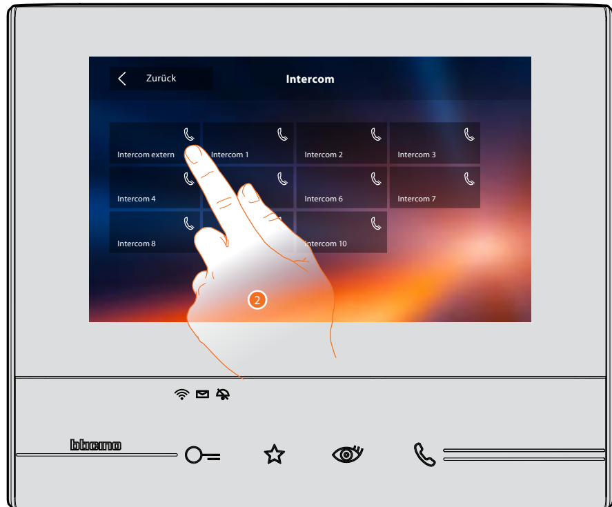
2. Berühren, um die Kommunikation mit dem gewünschten Intercom-Gerät herzustellen.
