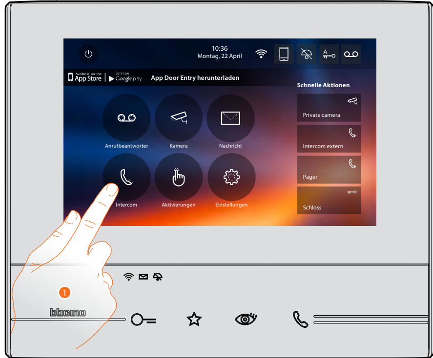
1. Berühren, um die verfügbaren Intercom-Geräte anzeigen zu lassen.
