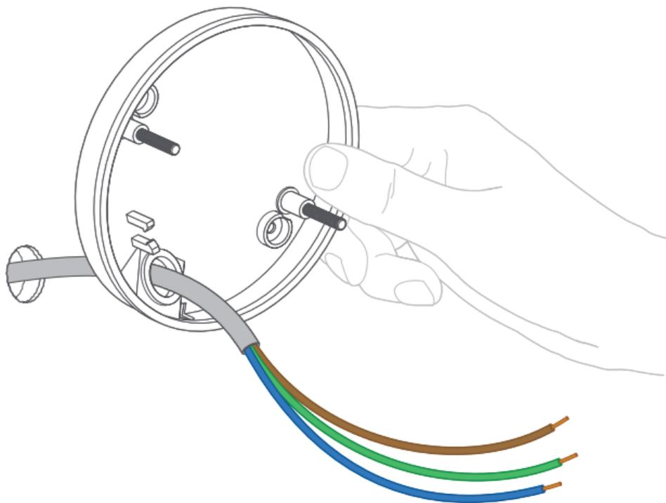
Bringen Sie die Halterung mit den beiden Halterungsstäben parallel zum Boden an (oder zur Wand bei senkrechter Befestigung an einem Überhang).
