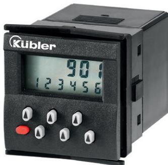
Der Typ 901 ist ein batteriebetriebener einfacher Impuls- und Zeitvorwahlzähler mit Zähl- und Rückstelleingang für 12...250 V AC/DC oder mit NPN-Eingang.
