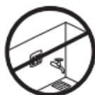
Der Thermostat darf nicht in feuchten Räumen angebracht werden. Platzieren Sie ihn in diesem Fall in einem angrenzenden Raum und verwenden Sie ausschließlich den Bodenfühler. Platzieren Sie den Thermostaten stets gemäß den lokalen IP-Schutzartvorschriften und verwenden Sie ausschließlich den Bodenfühler.
