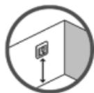
Platzieren Sie den Thermostaten in geeigneter Höhe an der Wand (in der Regel 80-170 cm).
