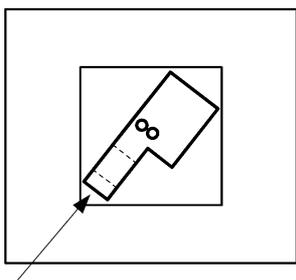
Testspule vertikal positionieren
