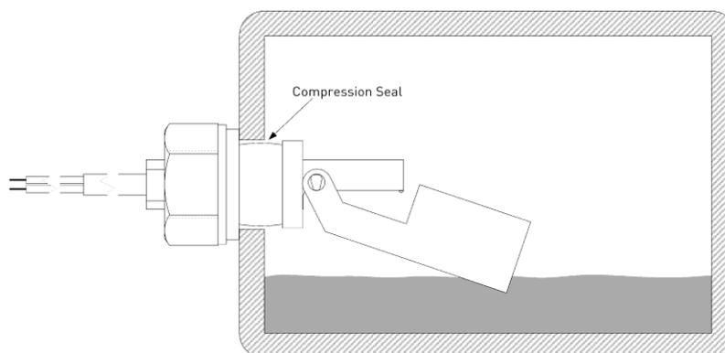
Bei Montage mit aufwärts gerichtetem Steigrohr kehrt sich das Schaltverhalten um.
