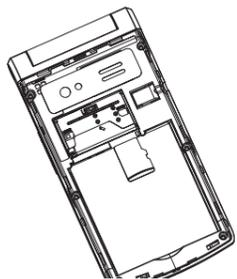
Schieben Sie die Karte vorsichtig in die Kartenhalterung unter der SIM-Kartenhalterung. Achten Sie darauf, dass die Kontakte der Speicherkarte nach unten zeigen und dass die Karte entsprechend dem markierten Bereich platziert wird (siehe Abbildung). Die Kontakte der Karte dürfen nicht zerkratzt oder verbogen werden.
