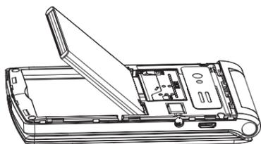
Und stellen Sie beim Hineinschieben in das Akkufach sicher, dass die drei Kontakte am Akku die drei Federkontakte im Akkufach berühren. Bringen Sie die Akkufachabdeckung durch leichtes Drücken wieder an, so dass sie einrastet.
