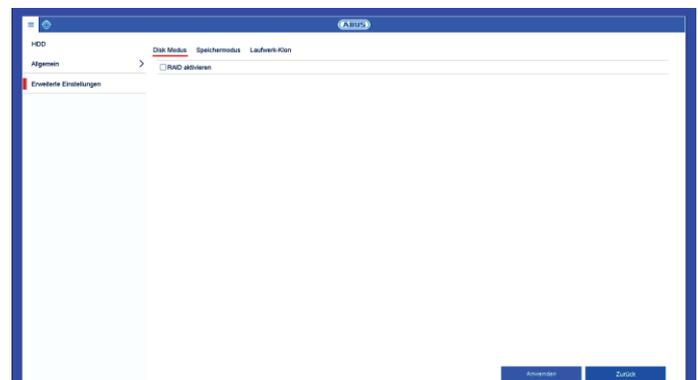
Aktivieren Sie durch Anklicken der Schaltfläche „RAID aktivieren“ die integrierte RAID-Funktion.
