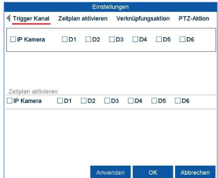
Wählen Sie durch Aktivieren der jeweiligen Checkbox aus, welcher Kamerakanal bei Alarmfall ausgelöst werden soll.
