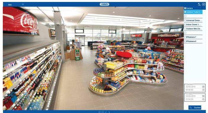
Mittels Wiedergabe „Bild“ können intern auf dem NVR gespeicherte Bilder (via Snapshot-Funktion aus der Liveansicht, Wiedergabe oder per Zeitplan gespeichert) wiedergegeben werden.
