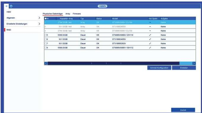
Diese Ansicht zeigt eine Auflistung aller angeschlossenen Datenträger am NVR. Zur weiteren Konfiguration stehen folgende Möglichkeiten zur Verfügung:
