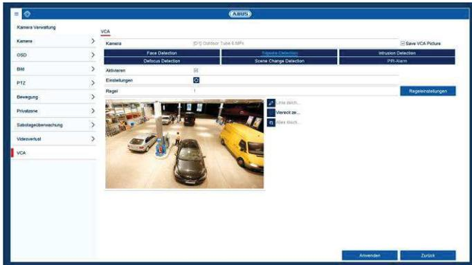
Die Funktion Video Content Analyse (VCA) ermöglicht eine Ereignissteuerung über Video-Analyse.
