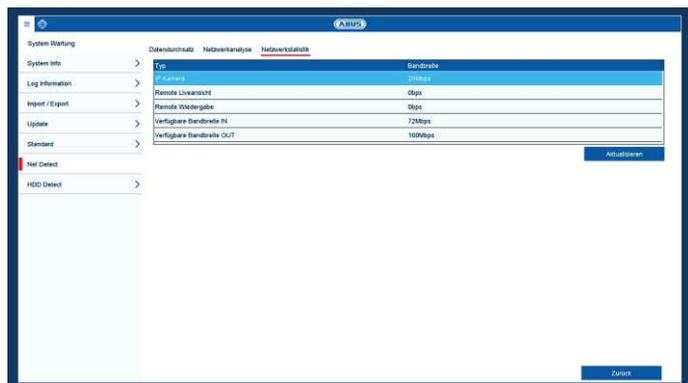
In diesem TAB wird die benutzte Bandbreite des Gerätes angezeigt.
