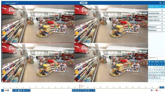
Mittels Wiedergabe „Multi-Timeshift“ kann ein einzelner Kamera-Kanal gleichzeitig zu verschiedenen Uhrzeiten gezielt ausgewertet werden. Hierzu wird der Kanal, je nach Einstellung bis zu 16x zeitversetzt wiedergegeben.
