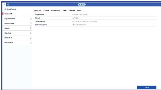
Im Informationsmenü werden die technischen Daten des Gerätes sowie Informationen zu den verschiedenen Einstellungen der Kameras, Aufzeichnung, Alarm, Netzwerk und HDD dargestellt. Dies ist z.B. hilfreich bei Support-Anfragen.
