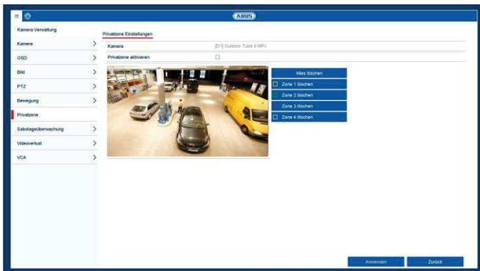
Wählen Sie bei „Kamera“ den zu bearbeitenden Kamerakanal aus und aktivieren sie die Checkbox „Privatzone aktivieren“.
