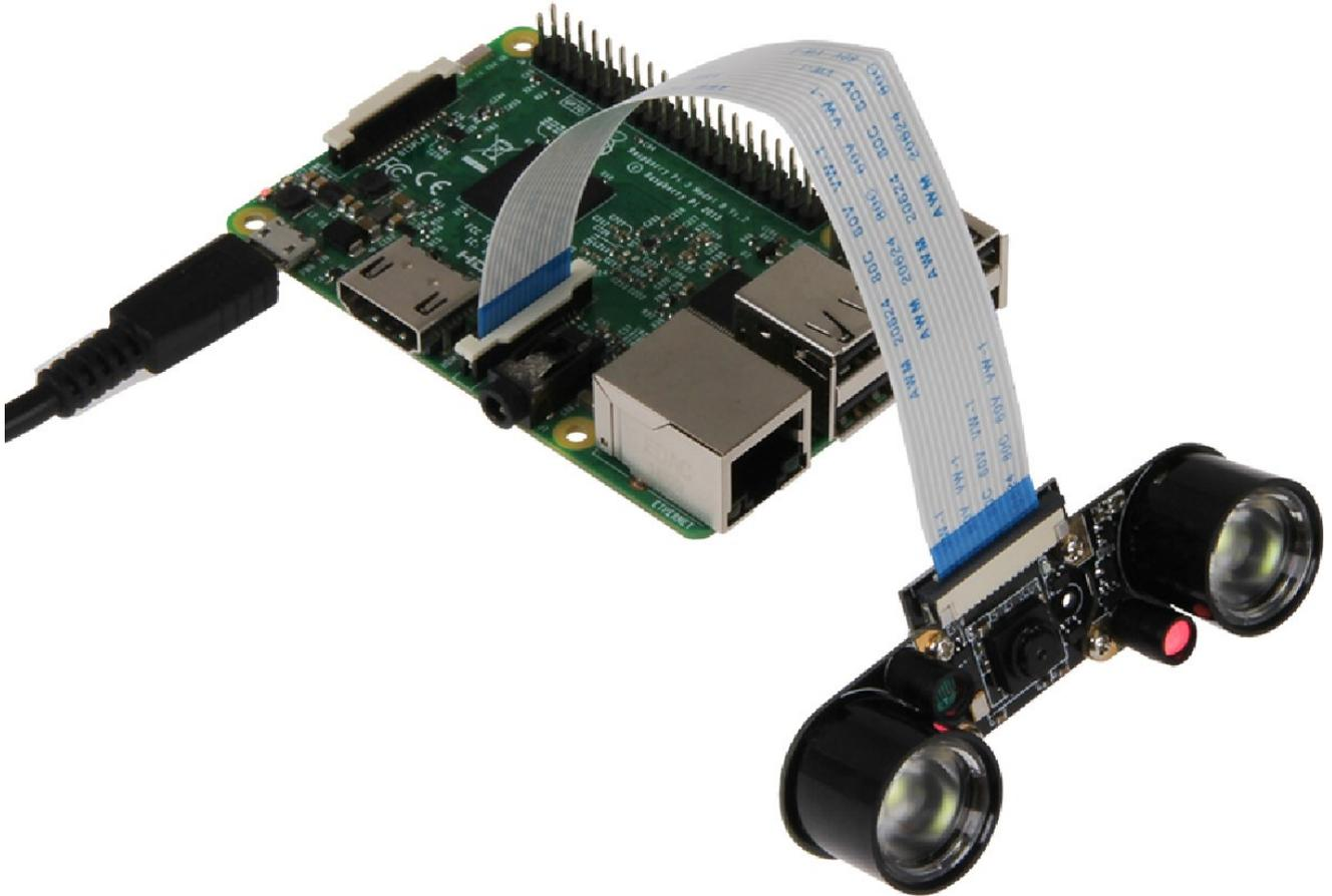
Schließen Sie das Kameramodul, wie im Bild zu sehen, mit dem beiliegenden Flachbandkabel an die CSI Schnittstelle Ihres Raspberry Pis an.
