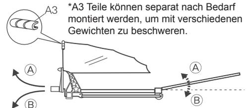
\*A3 Teile können separat nach Bedarf montiert werden, um mit verschiedenen Gewichten zu beschweren.
