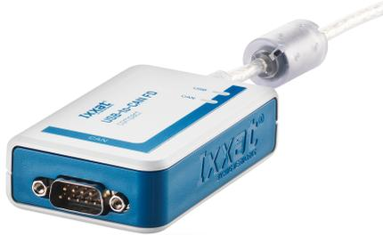
Das Ixxat USB-to-CAN FD compact mit galvanischer Trennung ist eine super einfache, robuste, vielseitige und kostengünstige Möglichkeit, einen Computer an ein CAN FD-Busnetzwerk anzuschließen. Es ist ein sehr zuverlässiges Arbeitspferd für CAN FD-Anwendungen z.B. im Bereich Test, Entwicklung, Wartung oder Steuerungsanwendungen.
