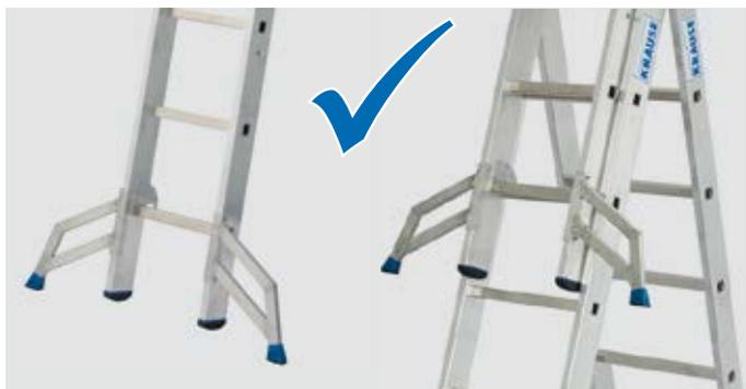
**i** Ohne eine Standverbreiterung in dieser Art sollten Leitern mit einer Länge über 3 m laut der neuen Norm DIN EN 131-1:2015 nicht mehr verwendet werden.
