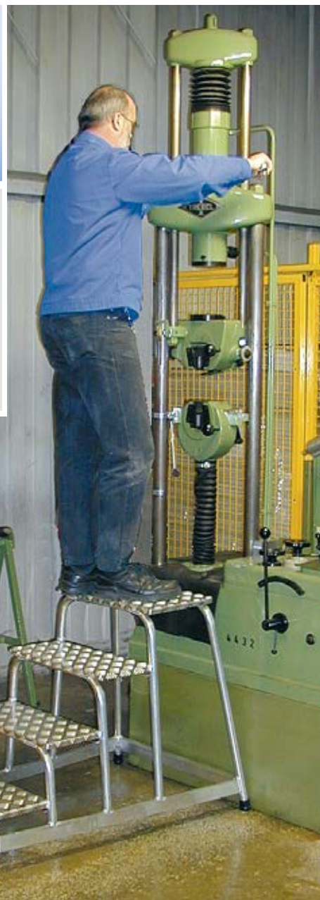
Höhenverstellbare Fußplatte als Sicherheitszubehör erhältlich
