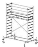
Arbeitshöhe: 4,40 m Gerüsthöhe: 3,40 m Standhöhe: 2,40 m
