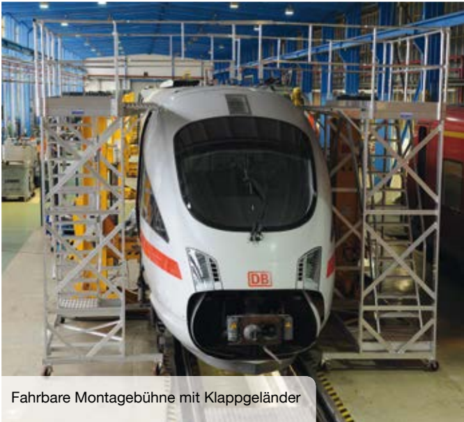
Laufboden mit Rammschutz und klappbarem Geländer
