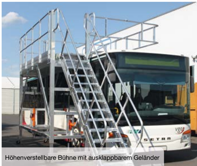
Fahrbare Bühne mit einseitigem Geländer
