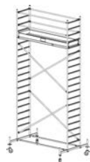
Arbeitshöhe: 6,40 m Gerüsthöhe: 5,40 m Standhöhe: 4,40 m
