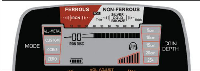
IM VOLLMETALL-Modus reagiert der *AT Max* auf sämtliche angetroffenen leitfähigen und magnetischen Eigenschaften, einschließlich Boden. Der Bediener hört ununterbrochen, was die Suchspule im Boden „sieht“. Daher ist es eine korrekte Ground Balance unerlässlich im VOLLMETALL-Modus. Natürlich im Boden vorkommende Mineralien müssen beim Ground Balance-Verfahren ausgeschlossen werden, damit nur die Signale von Metallobjekten detektiert werden.
