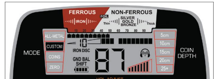
Ground Balance Werte über 75 steigen in Viertelschritten der Auflösung. Die obige Abbildung zeigt einen Ground Balance Wert von 87.5. Über der Ganzzahl 87 wird jeder Viertelschritt durch 5 Segmentblöcke in der oberen Skala angezeigt.
