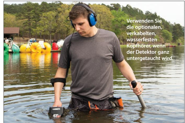
Verwenden Sie die optionalen, verkabelten, wasserfesten Kopfhörer, wenn der Detektor ganz untergetaucht wird.
