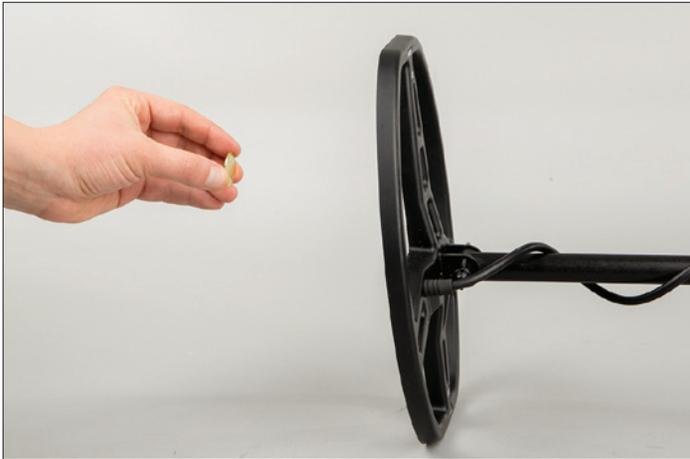
Setzen Sie die Suchspule zur Durchführung eines Prüfversuches auf eine flache, nichtmetallische Oberfläche, die ca. einen Meter von anderen Metallobjekten entfernt ist.
