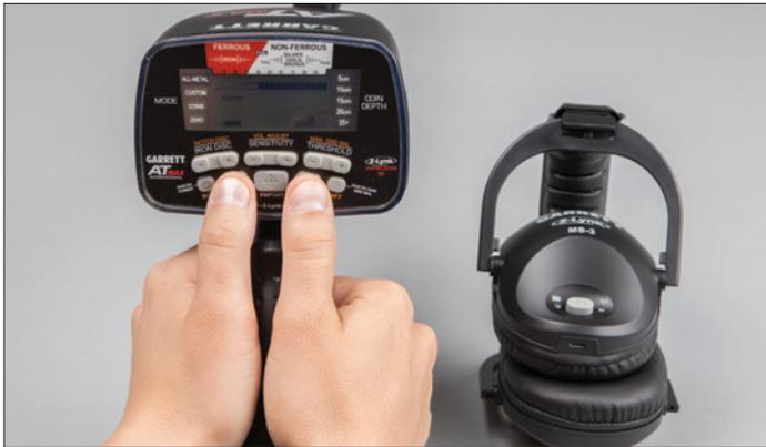
**VERBINDUNG:** Schalten Sie die Kopfhörer ein und halten Sie sie innerhalb von 0,6m (2 Fuß) vom *AT Max* entfernt. Drücken Sie dann gleichzeitig die Z-Lynk Tasten (IRON AUDIO und FREQ) und lassen Sie sie los.
