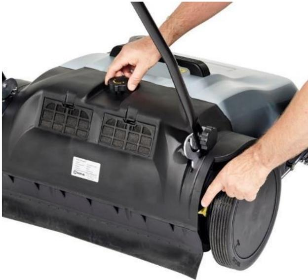
Die Hauptkehrwalze wird „riemenlos „ durch ein Getriebe angetrieben und dreht sich auch bei Wendungen nach links oder rechts
