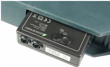
Bild 1 Ableitstrommessadapter am PROFITEST MXTRA
