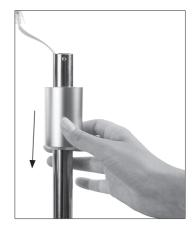
• Führen Sie das aus Rohr 2 herausragende Kabel durch die untere Öffnung des Windrichtungssensors nach oben.
