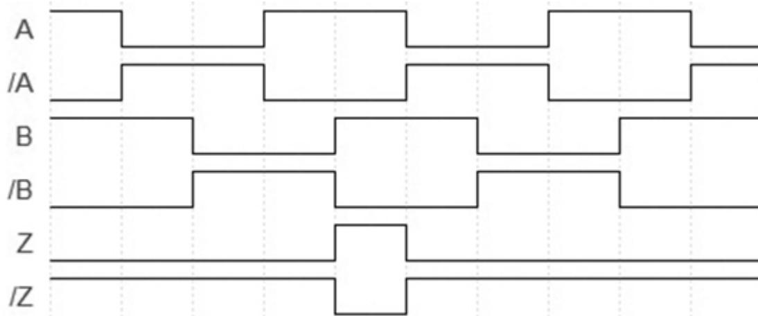
Drehung im Uhrzeigersinn (Sicht auf Welle)
