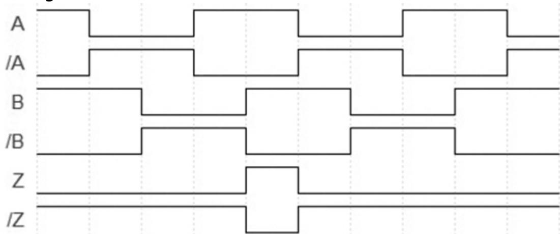
Drehung im Uhrzeigersinn (Sicht auf Welle)
