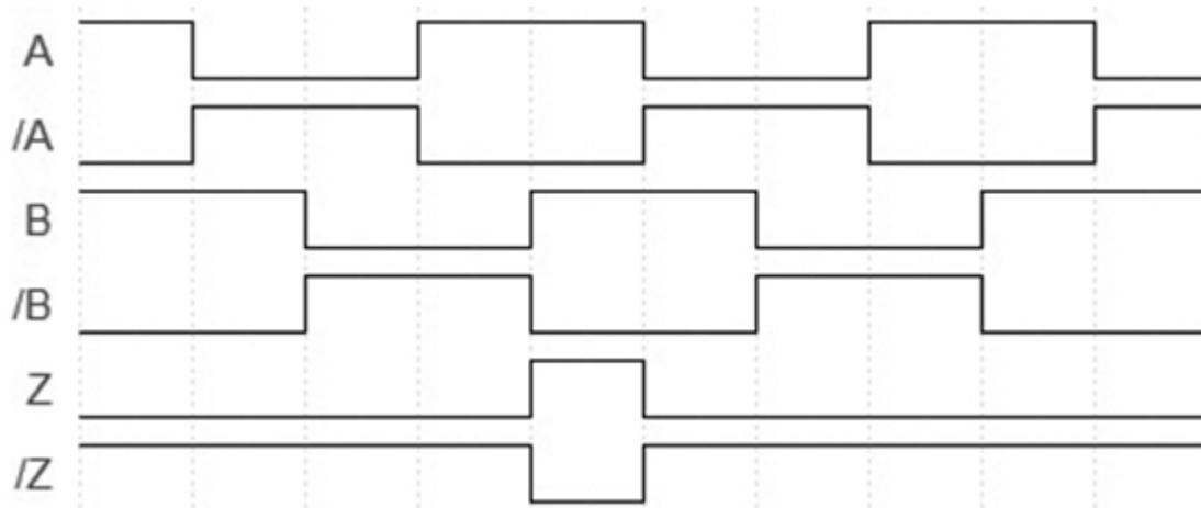
Drehung im Uhrzeigersinn (Sicht auf Welle)
