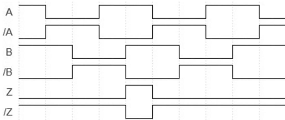
Drehung im Uhrzeigersinn (Sicht auf Welle)
