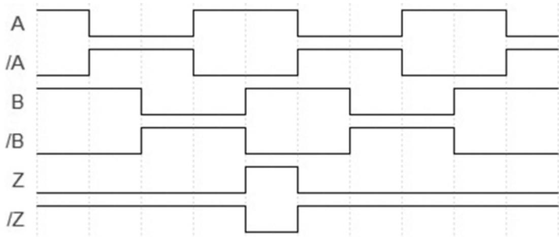
Drehung im Uhrzeigersinn (Sicht auf Welle)
