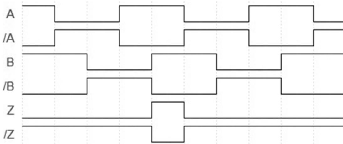
Drehung im Uhrzeigersinn (Sicht auf Welle)
