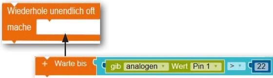
Gut, das hättest du. Wie geht es weiter? Entspricht der analoge Wert am Pin 1 kleiner 22 also die Lichtschranke wird unterbrochen, soll der Motor die Schranke öffnen. Öffnen bedeutet, der Motor dreht nach „rechts“. Somit musst du den nachfolgenden Befehl einbauen.
