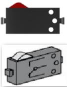
Taster zählen zu den Berührungssensoren. Betätigst du den roten Knopf, wird im Gehäuse ein Kontakt mechanisch umgelegt und es fließt Strom zwischen den Anschlüssen 1 und 3. Gleichzeitig wird der Kontakt zwischen den Anschlüssen 1 und 2 unterbrochen. Somit kannst du den Taster als Umschalter in deine Modelle einbauen.
