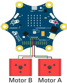
Möchtest du bei späteren Modellen mit zwei Motoren arbeiten, werden diese, wie im Schaltbild dargestellt, angeschlossen.
