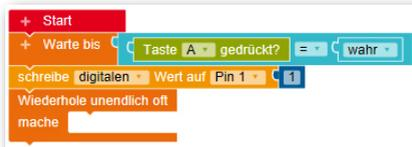
Was soll jetzt als nächstes geschehen? Das Programm wartet, bis der Fußgänger die Anforderungstaste drückt. Wie du aus dem Schaltplan erkennen kannst, ist diese am Pin 3 des Calliope mini angeschlossen.
