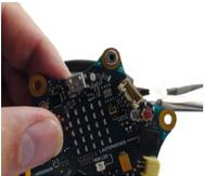
Stecke die Steckbuchse von oben in die Anschlussstelle. Diese wird von unten mit einer Mutter fest verschraubt. Verwende dazu eine kleine Zange aus dem Werkzeugkasten oder aus dem
