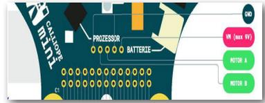
Um den Motor für dein Modell zu steuern, musst du einen kleinen Trick anwenden. Zuerst wird der Motor nur an den beiden Leitungen mit den Farben schwarz und rot angeschlossen.
