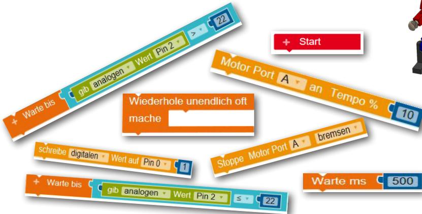
Du beginnst natürlich dein Programm mit dem „Startbefehl“. Danach muss die LED am „digitalen Pin 0“ eingeschaltet werden. Damit die Lichtschranke richtig funktioniert, gibst du anschließend noch den Befehl „Warte ms 500“ ein.
