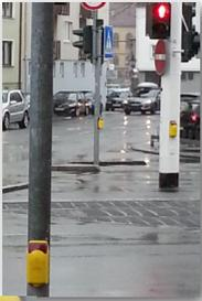
Der Techniker schaltet zunächst in einem Schaltkasten die Anlage ein. Danach leuchtet die rote Lampe. Erst wenn der Fußgänger auf den Anforderungstaster drückt, schaltet die Anlage auf grün um und er kann die Straße überqueren.
