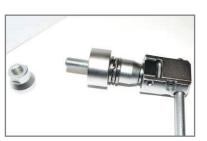
Abhängig vom benötigten Lochdurchmesser das passende Stanzwerkzeug auswählen.
