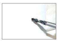
Mit dem Zentrierbohrer an definierter Stelle ein Loch vorbohren.
