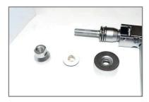
Stanzwerkzeug lösen, Stanzlinse entfernen und Werkzeug für den folgenden Einsatz reinigen.
