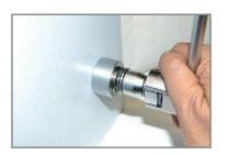
Das Stanzwerkzeug in das vorgebohrte Loch einsetzen. Der "kleinere" Stanzkörper sollte außen sitzen und dann nach innen durchgezogen werden.
