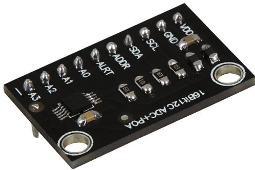
Der Raspberry Pi besitzt im Gegensatz zum Arduino keine analogen Eingänge bzw. es ist kein ADC (analog digital converter) im Chip des Raspberry Pi's integriert. Dies schränkt den Raspberry Pi ein, wenn man Sensoren einsetzen möchte, bei denen Werte nicht digital ausgegeben werden können.
