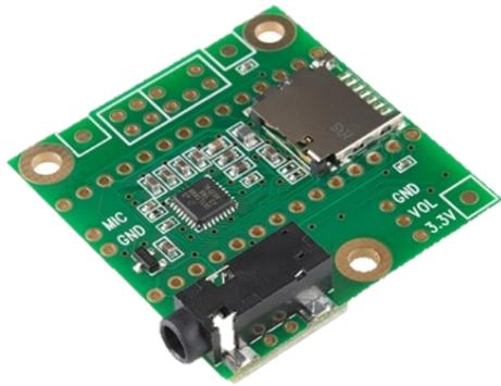
Dieses Audio-Board ist ein Addon für die Entwicklungskarten Teensy 3.0 und 3.1. Das Audio-Board ist eine anwenderfreundliche Lösung, um Ihr Teensy-Projekt mit Audio in hoher Qualität (16 Bit, 44,1 kHz) auszustatten. Das Teensy Audioboard arbeitet mit einem SGTL5000-Stereo-Codec mit Kopfhörerverstärker-IC, um Audiodateien zu dekodieren und auszugeben. Die Cortex-M4 DSP-Anweisungen des Teensy-Entwicklerboards ermöglichen FFT in Echtzeit.
