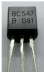
Dieser Transistor hat die Typenbezeichnung BC547B. Mit dieser Bezeichnung kann man genau den richtigen Typ auswählen, der übrigens von mehreren Firmen hergestellt wird. Oder man kann im Internet nach dem Datenblatt suchen. Darin stehen die entscheidenden Eigenschaften und Messwerte. Kurz zusammengefasst: Dieser NPN-Transistor verträgt eine Spannung von 50 V und einen Strom von 100 mA. Und er kann den Strom mindestens 200-fach verstärken.
