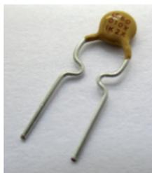
Viele Sicherungen brennen einfach durch, wenn man einen Kurzschluss baut. Aber diese Speziälsicherung ist anders. Es handelt sich um eine selbstrückstellende Sicherung, die man auch PTC-Sicherung nennt. Wenn bei einem Kurzschluss ein
