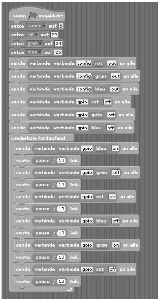
Das Programm 11rgbLed02 verwendet Variablen für die GPIO-Pinnummern.
