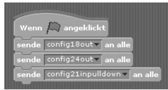
Die GPIO-Pins werden initialisiert.
