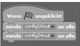
Das Programm besteht aus mehreren Teilen – für die Bühne und die Objekte. Wählen Sie zuerst im Objektfenster die Bühne. Der Skriptblock der Bühne initialisiert beim Klick auf das grüne Fähnchen die GPIO-Pins.
