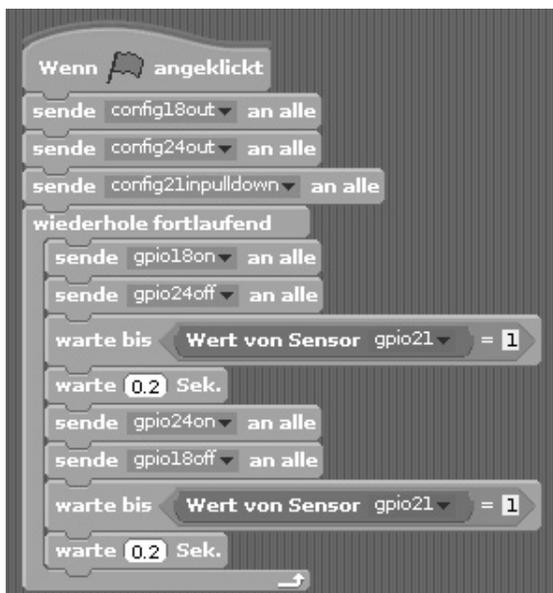
Das Programm 05Led05 steuert die beiden LEDs über einen Taster.
