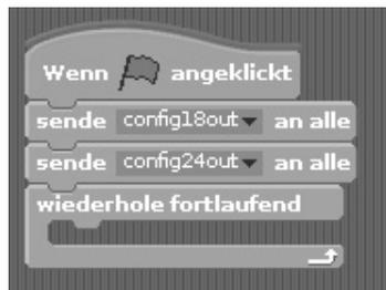
Eine **wiederhole fortlaufend**-Schleife sorgt dafür, dass die beiden LEDs endlos blinken, und zwar so lange, bis der Benutzer auf das rote Stoppsymbol oben rechts in Scratch klickt.
