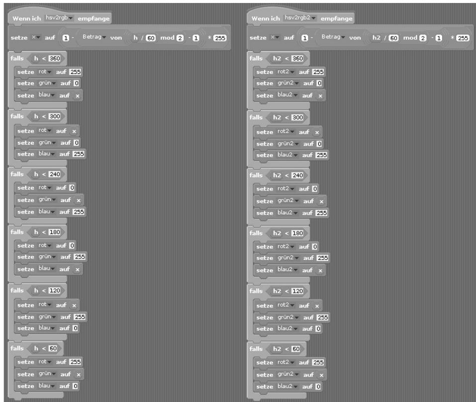
Diese Blöcke ermitteln die RGB-Farben für die beiden RGB-LEDs aus H-Werten.
