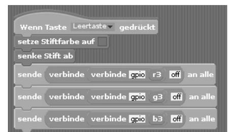
Beim Drücken der Leertaste wird die RGB-LED abgeschaltet.
