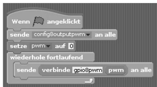
Das Programm 08Led08 dimmt die beiden LEDs.
