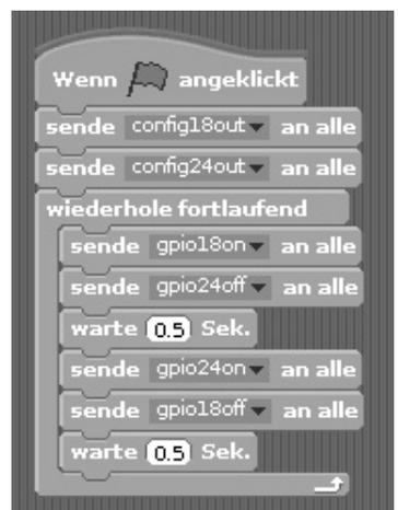
Das Programm 03led03 steuert die beiden LEDs.
