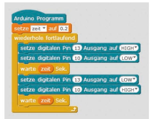
Das Programm 03mb1ock lässt zwei LEDs abwechselnd mit einstellbarer Geschwindigkeit blinken.
