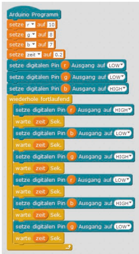
Verschiedene Farben auf einer RGB-LED.
