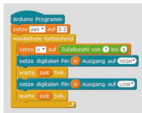
Das Programm 07mblock01 lässt drei LEDs zufällig blinken.
