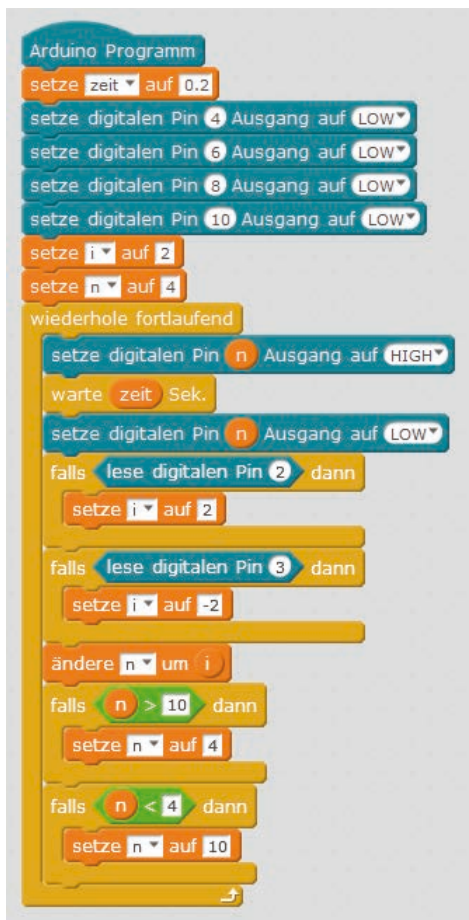
Lauflichtrichtung mit zwei Tastern umschalten.
