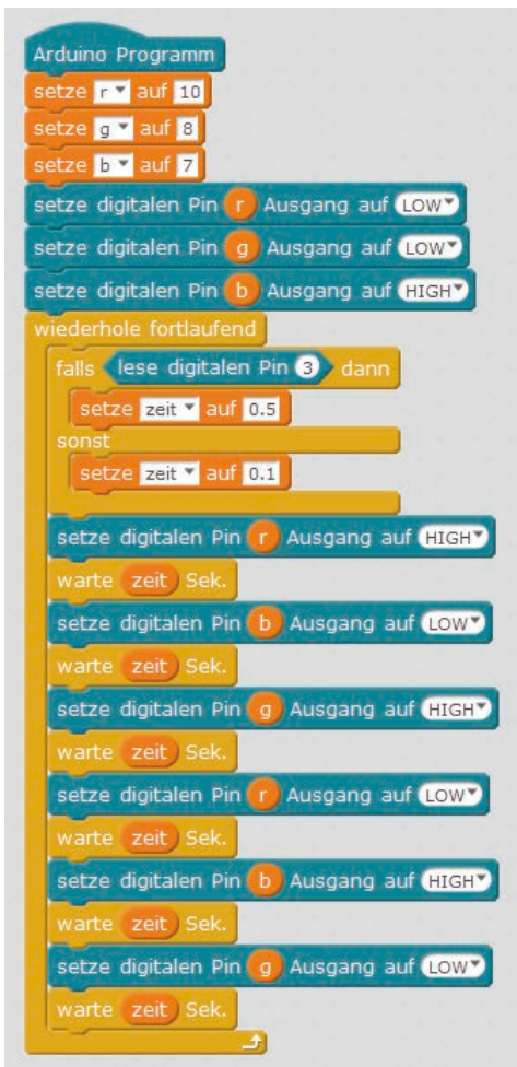
Das Programm 12mblock schaltet eine RGB-LED und einzelne LEDs.
