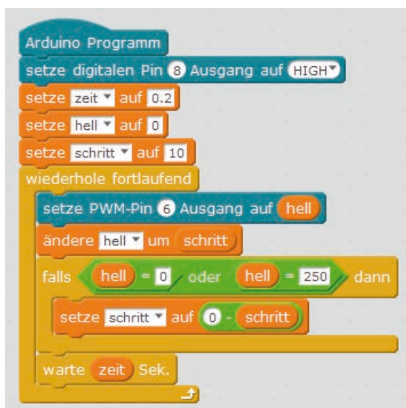
Das Programm 08mb1ock dimmt eine LED am PWM-Ausgang.
