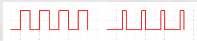
Links: Tastverhältnis 50 % – rechts: Tastverhältnis 20 %.
