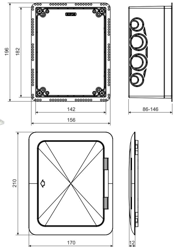
Produktbeschreibung: entwickelt für Leitungen mit einer Spannung bis 400 V
