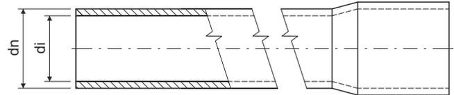
**Produktbeschreibung:** Kunststoffstangenrohr, flammwidrig, mit angeformter Muffe
