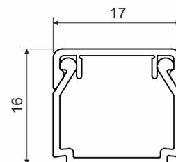
Produktbeschreibung: bestimmt zur Installation von Niederspannungsleitungen
