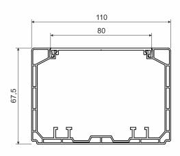
Produktbeschreibung:: vorgesehen für die Installation von Niederspannungsleitungen
