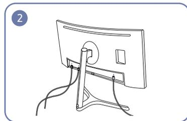
Schließen Sie die Kabel an die geeigneten Anschlüsse an.
