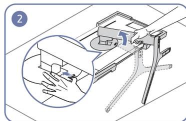
Drücken Sie die Taste nach oben und halten Sie sie gedrückt. Drehen Sie die Halterung für den Standfuß der Anzeige 10° im Gegenuhrzeigersinn.
