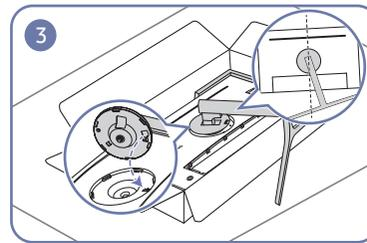
Platzieren Sie die Halterung für den Standfuß der Anzeige gemäß der Position der Befestigungselemente auf dem Gerät.
