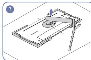
Nachdem Sie die Halterung für den Standfuß der Anzeige 10° im Gegenuhrzeigersinn gedreht haben, heben Sie den Standfuß der Anzeige an, um ihn von dem Gerät zu trennen.
