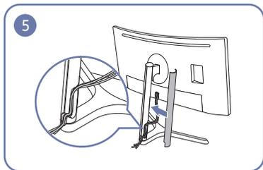
Decken Sie die LINKE ABDECKUNG DER STANDFUSS-HALTERUNG ab.
