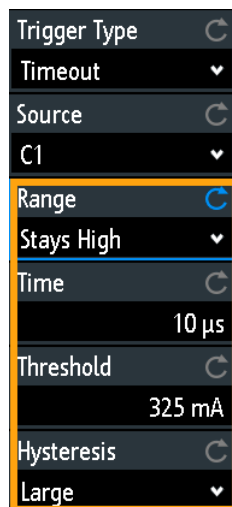
Bild 5-9: Menü Zeitüberschreitung (Timeout)-Trigger
