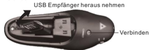
Wenn der USB Empfänger an einen PC angeschlossen wurde, empfängt dieser das Signal normalerweise automatisch vom Sender. Sollte dies jedoch einmal nicht der Fall sein, drücken Sie bitte die Taste "Connect" um die Verbindung neu herzustellen.
