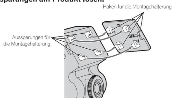
Wiederholen Sie die Schritte in umgekehrter Reihenfolge, um das Produkt wieder anzubringen. Richten Sie die Haken an der Montagehalterung an den Aussparungen am Produkt aus und schieben Sie das Produkt dann von der LCD-Anzeigeseite des Produkts aus gesehen nach rechts (in die Richtung wie vom Symbol „LOCK➔“ an der Montagehalterung angezeigt).
