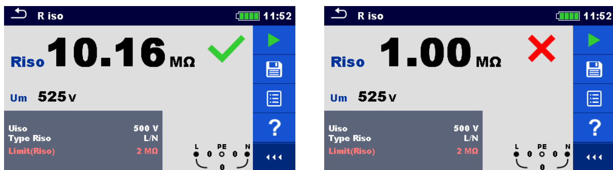
Abbildung 7.9: Beispiele für Ergebnisse der Isolationswiderstandsmessung
