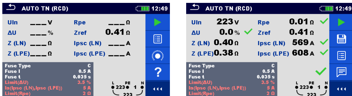
Abbildung 7.132: Beispiele für Ergebnisse der AUTO TN (RCD) Messung
