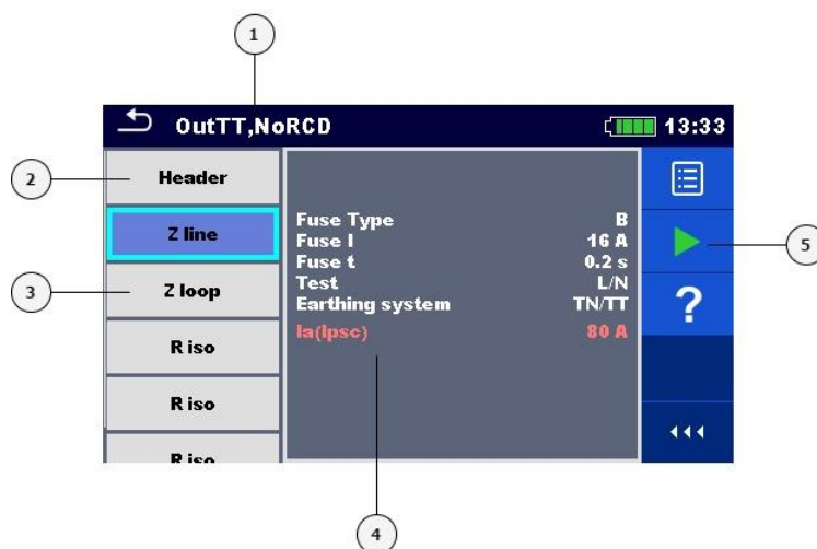
Abbildung 8.4: Bildschirmaufbau im Menü Auto Sequence® Anzeige – Messung ausgewählt
