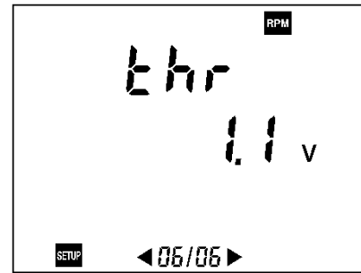
Abbildung 54: Anzeige des mit dem Spannungsgrenzwert des tachymetrischen Messfühlers verbundenen Parameters.
