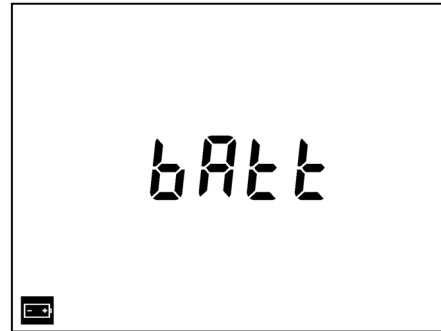
Abbildung 5: Bei der Anzeige der schwachen Batteriekapazität muss ein Austausch der Batterien erfolgen.
