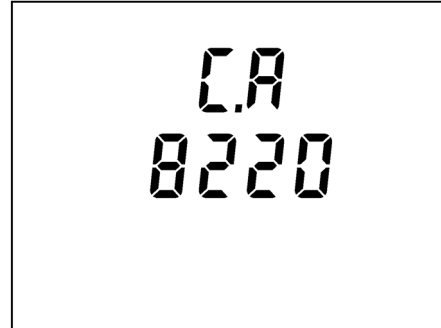
Abbildung 70: Das zweite Display bei der Inbetriebnahme des Gerätes (ohne Anschluss eines Stromwandlers).
